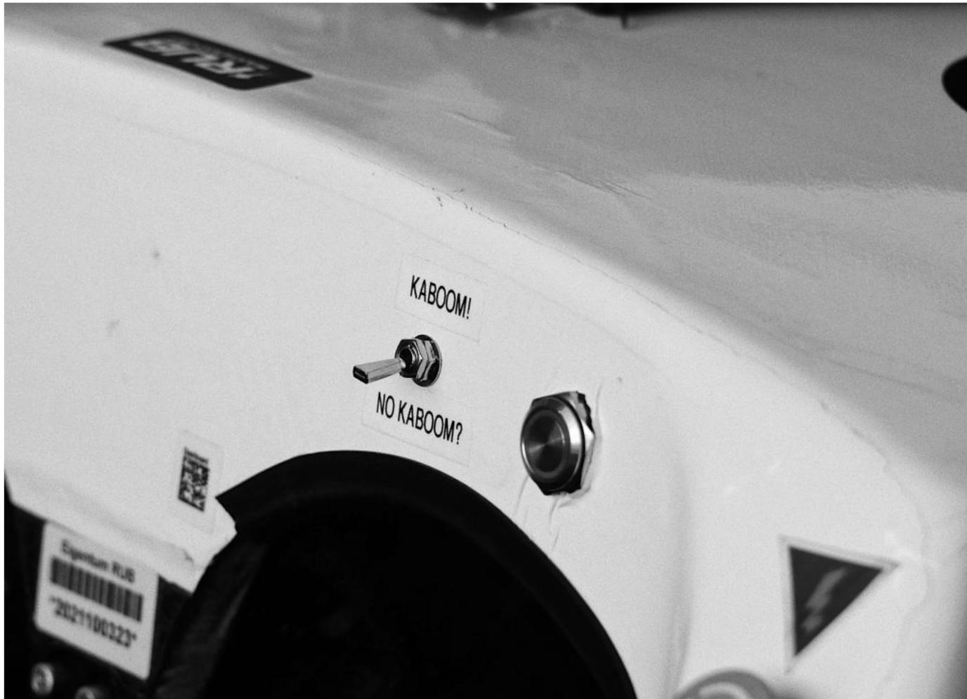
disziplin angebrachter Schalter der es erlaubt, Zündung und Einspritzung manuell auszuschalten. In Anlehnung an das ungeliebte und unüberhörbare Geräusch, ist er auf „Kaboom-Switch“ getauft worden.
